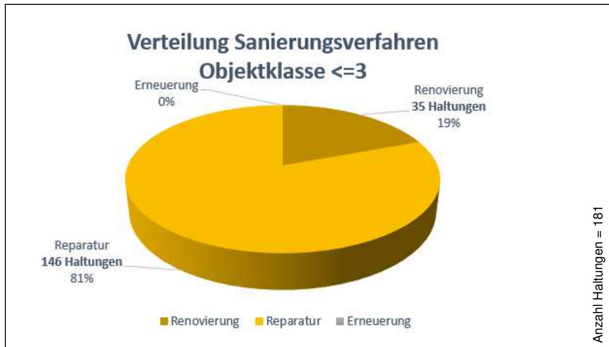
Abbildung 3: Verteilung der Sanierungsverfahren bezogen auf die Anzahl der untersuchten Haltungen mit Objektklasse <=3.
