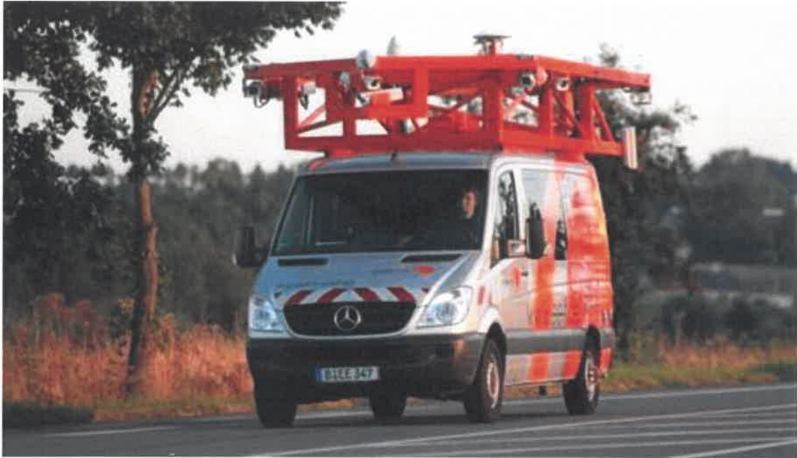
Abb. 4: kinematisches Messfahrzeug eagle eye XL1
