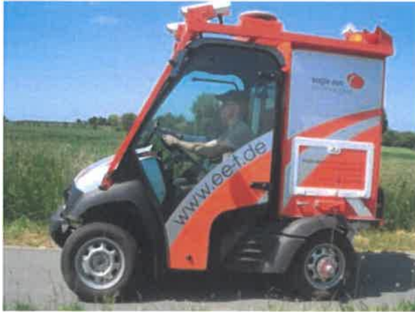
Abb. 5: kinematisches Schmalspurfahrzeug eagle eye XS
